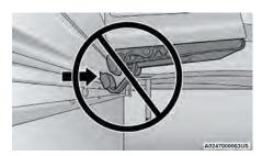
**Improper Clamp Position**
