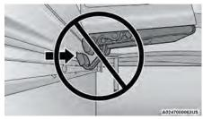
**Improper Clamp Position**
