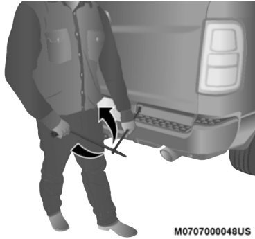
Rotating The Lug Wrench Handle
