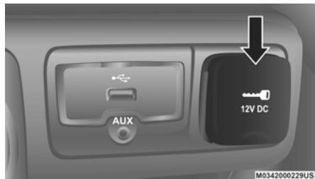
12 Volt Power Outlet
