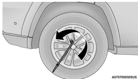
Loosen Lug Nuts
